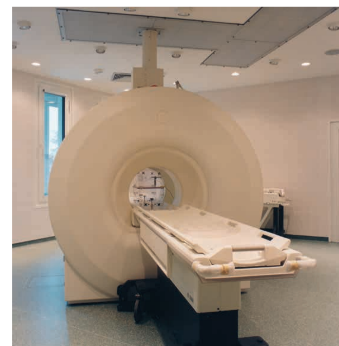
Offener MRT mit zwei nebeneinanderstehenden Magnet- ringen (Foto: Foto-Schröer, Kranichfeld, 2000)
